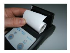
Der Drucker ist für eine Papierbreite von 57,0 ± 0,5 mm, Wickeldurchmesser von 31 mm, Papierdicke 60 g/m2 spezifiziert.
