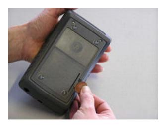
Im Batteriefachboden befindet sich eine Öffnung, durch die der 7polige Akku-Anschluss-Steckverbinder zugänglich ist. Durch vorsichtiges Ziehen am Akku-Pack-Anschlusskabel kann der Stecker aus der Steckerbuchse gezogen werden. Mit einer Spitzzange (Pinzette) kann der Stecker des neuen Akku-Packs eingesteckt werden.
