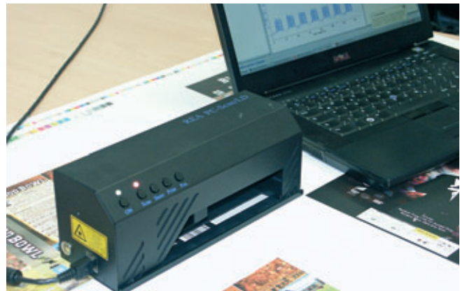
Messung von Druckbögen in der Fertigung
